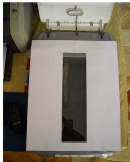
Slika4: Izgled skenera pripremljenog za skeniranje kolotova drveta
