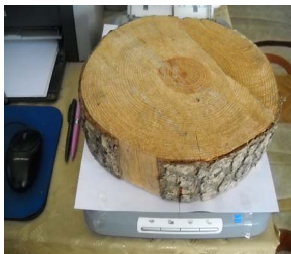
Slika6: Postavljanje pripremljenog i obeleženog drvenog koluta za skeniranje
